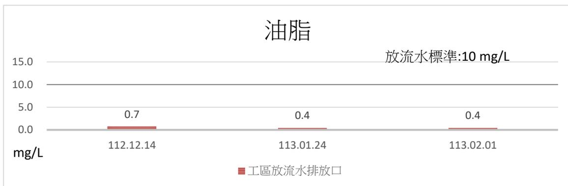
圖 2.5-8 工區放流水油脂監測結果比較圖
