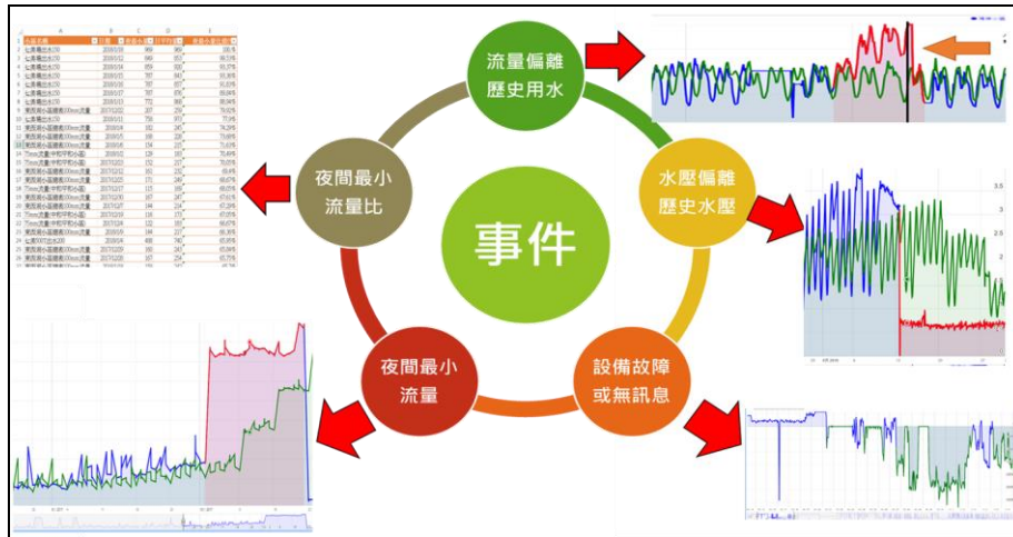
圖 3-6、台水公司小區管網漏水自動偵測大數據分析軟體示意圖
