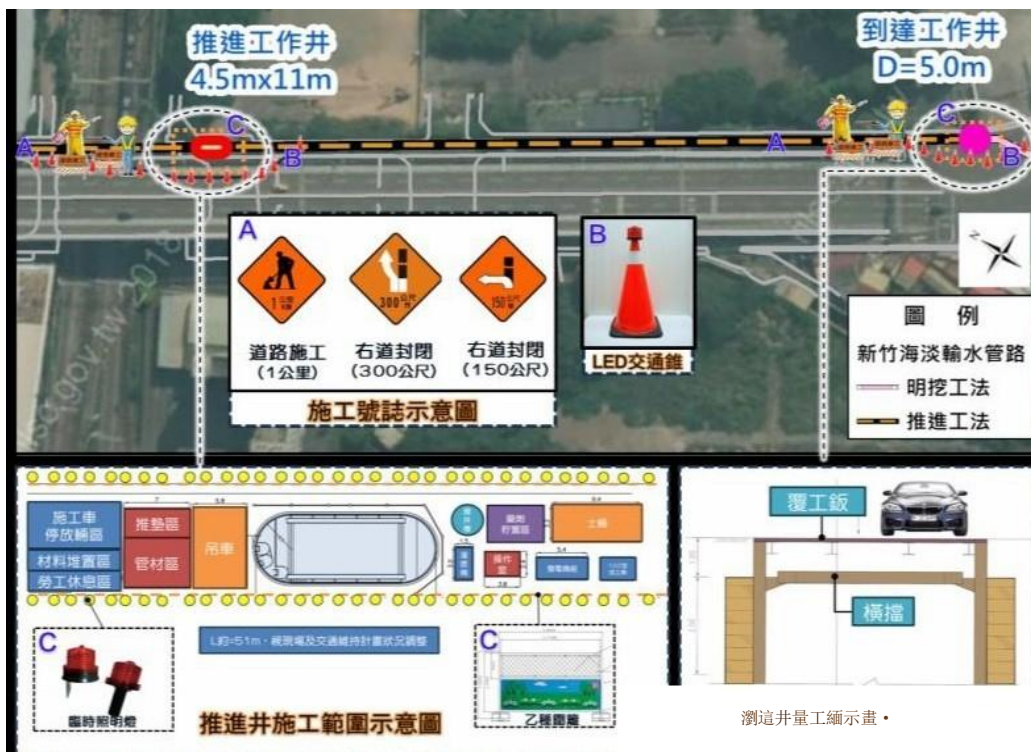
圖 12-3 工區腹地充裕之明挖覆蓋交通維持示意圖
