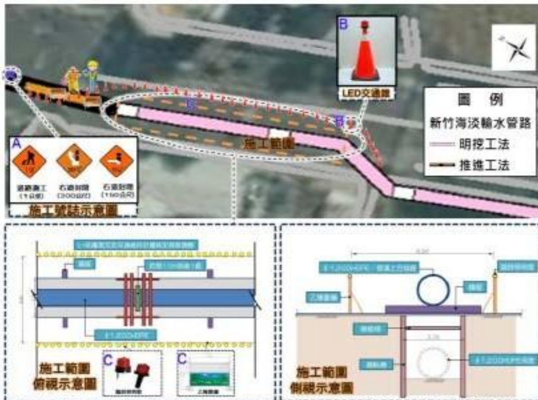
圖 12-2 工區腹地狹小之明挖覆蓋交通維持示意圖
