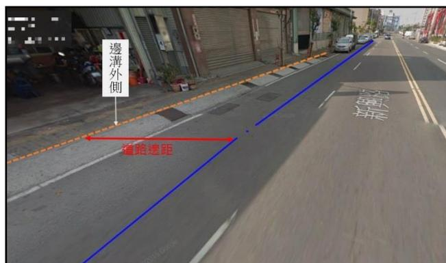
圖二、單側有邊溝，但埋管於另一側，仍以該「邊溝外側線」為量測基準。
