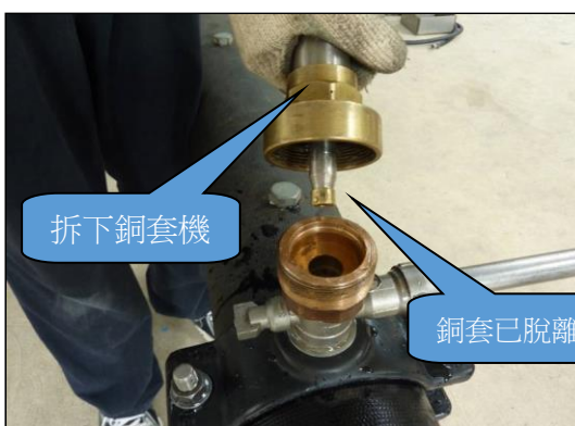
(鬆開轉接頭拆下銅套機)
