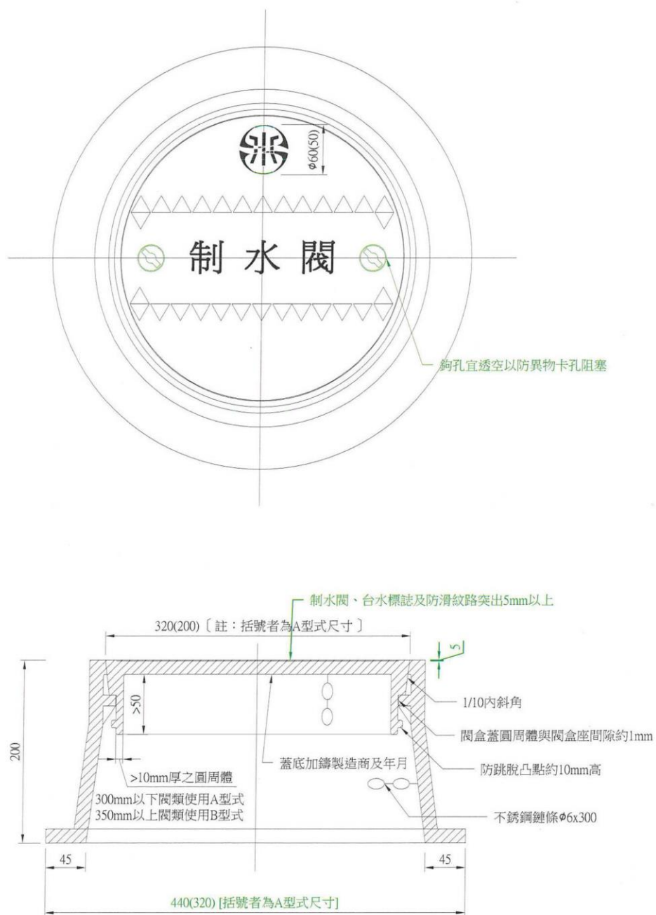
自來水工程用鑄鐵閥盒制水閥示意圖
