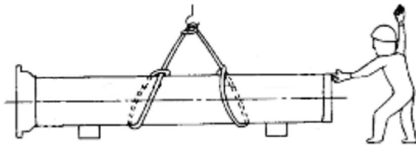
3.3.8 水管保護:在水管裝接期間，乙方應防止石塊或其他堅硬物體墜入管溝，以免水管遭受損傷，凡工作暫停或休息時，管口端需封蓋牢固，以防不潔之物進入管內。水管接裝妥善，尚未試壓前，應將管身部分先行覆土，以求保護。
