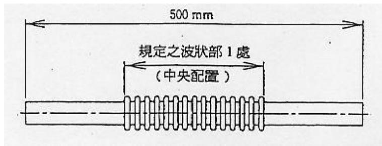
圖 2 波狀管試驗樣本之尺寸
