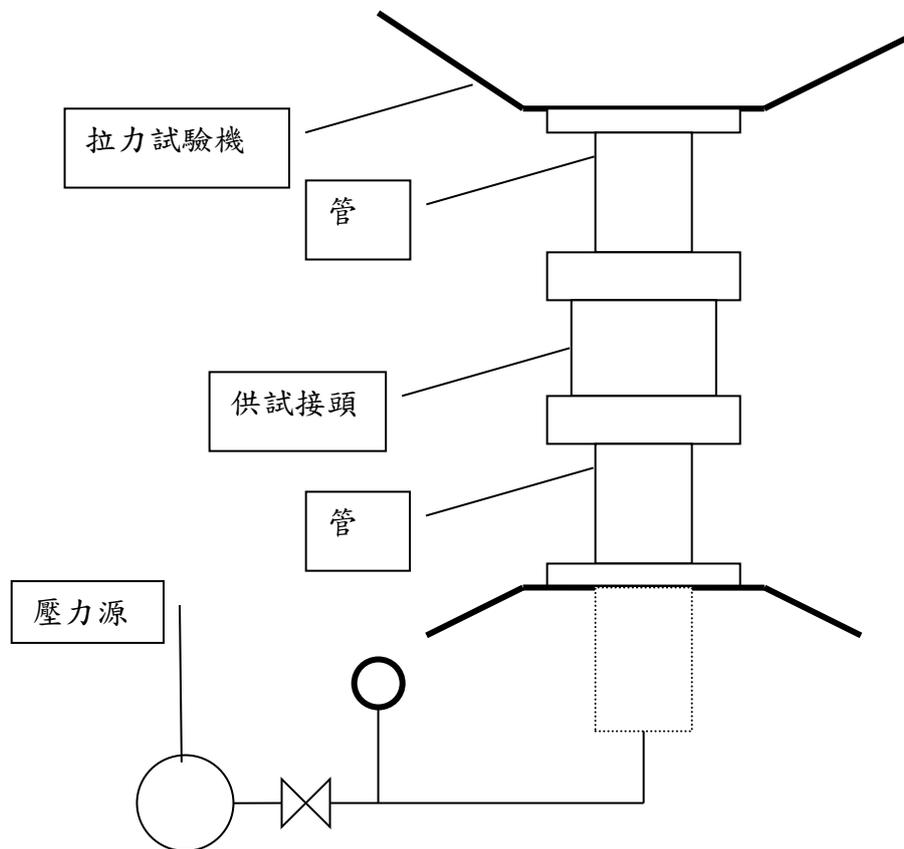
圖 4 拉拔力試驗裝置例
