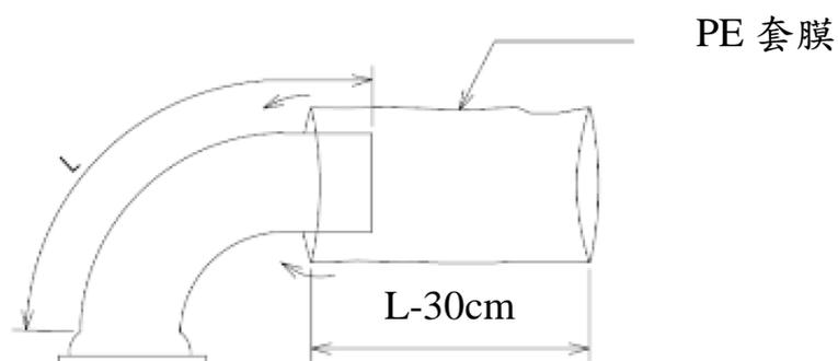
乙、整理 PE 套膜使位於管身中央，皺摺部分使其全部集中於彎管內側，並儘量整理使其他部分平順。
