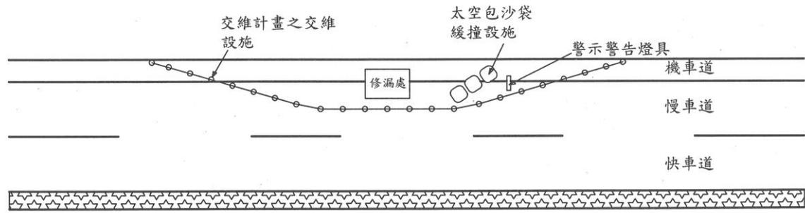
修漏工程緩撞設施示意圖
