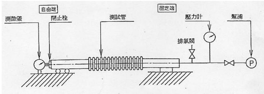
圖 3 伸縮量及殘留伸縮量試驗裝置
