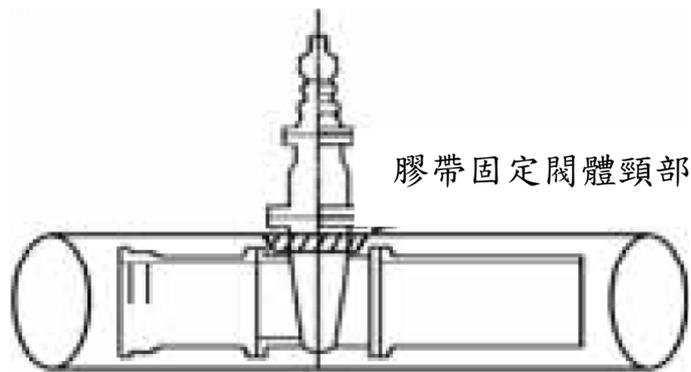
己、以束線帶將 PE 套膜固定於本管。二端 PE 套膜各超出管線 50cm。
