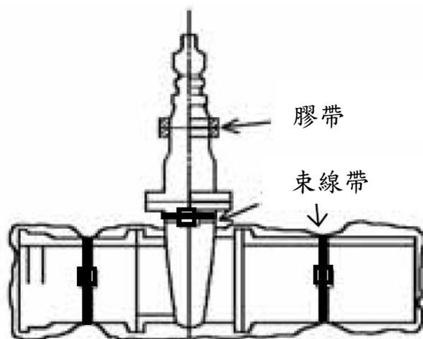
辛、主管二端多餘之 PE 套膜反折，以利機械接頭處施工。
