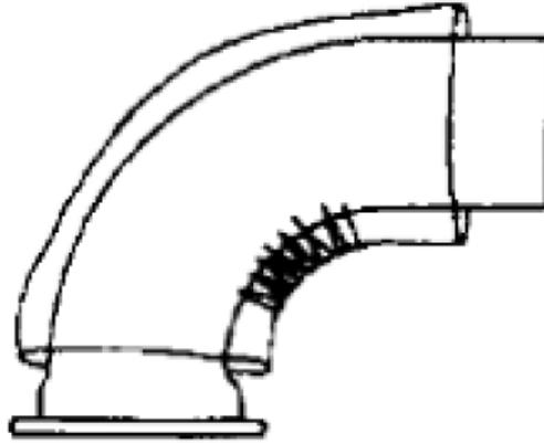
丙、整理平順後多餘部分摺疊方式如前所述，二端 PE 套膜以束線帶固定，並用膠帶固定側面 PE 套膜。
