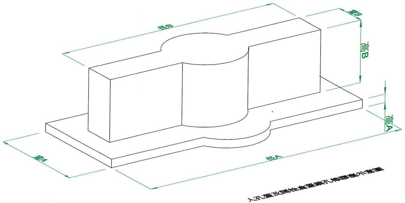
附圖：人孔蓋鉤孔橡膠塞示意圖
