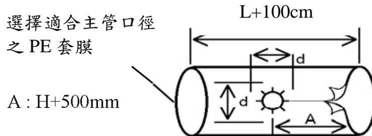
丙、選適合分歧管口徑( $d$ )之 PE 套膜，確認分歧管管徑及長度，其長度為  $B(I+50\text{cm})$ ，再以  $D/2$  長度裁剪等分為 6 部分。
