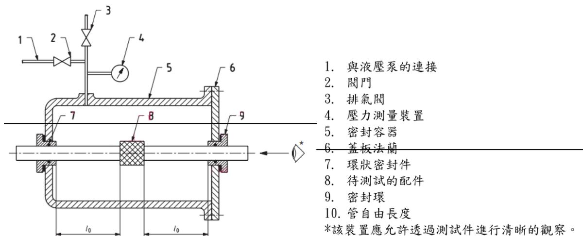
圖 7 負壓試驗裝置例(僅適用於管徑 ≤ 63mm)
