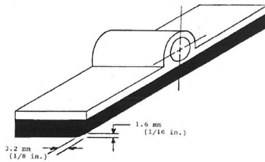
圖 3 橡膠滑片磨損量(摘錄自 ASTM E303)
