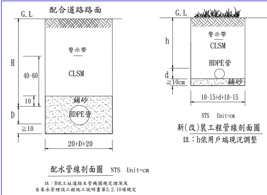
圖 1、配水管及新(改)裝工程管線剖面圖
