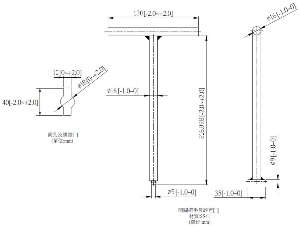
自來水工程用鑄鐵制水閥、排泥閥、消防栓、排水排氣閥盒鈎孔及開關把手設計圖
