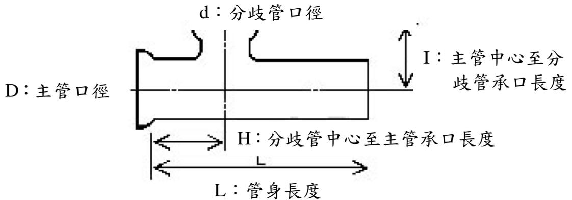
乙、選擇適合主管口徑之 PE 套膜，其長度為管身長度加上 100cm，並擇其一端剪開長度為  $A(H+50\text{cm})$ ，再以  $A$  端點處為中心，裁剪一個直徑近似分歧管口徑大小( $d$ )的圓，俾利套入。
