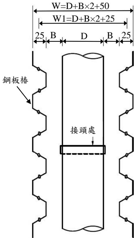
圖 3 鋼板樁及埋管斷面示意圖
