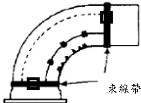
丁、直管機械接頭處接合時，其施作方式與直管作法相同。另以包覆分水鞍相同尺寸之 PE 套膜於接頭處以膠帶密封並以束線帶妥為固定。
