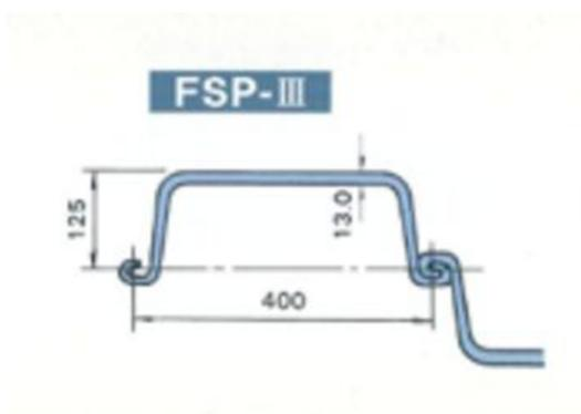
圖 5 鋼板樁 FSP III 型示意圖
