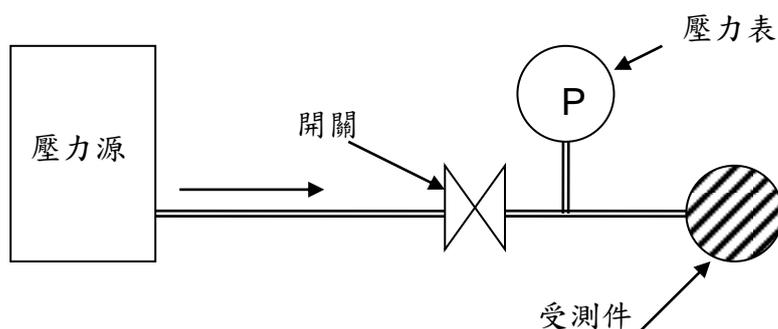
圖 1 波狀管耐壓試驗裝置圖
