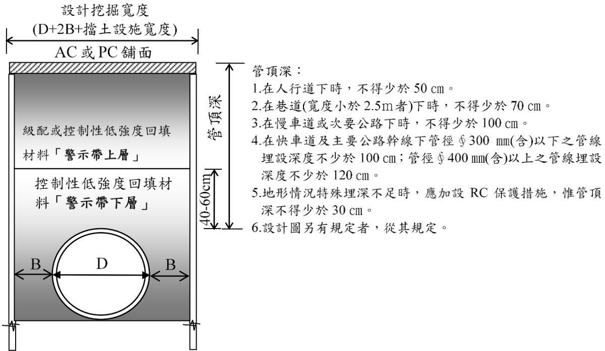
[圖 1、非塑膠類管種直管斷面示意圖]
