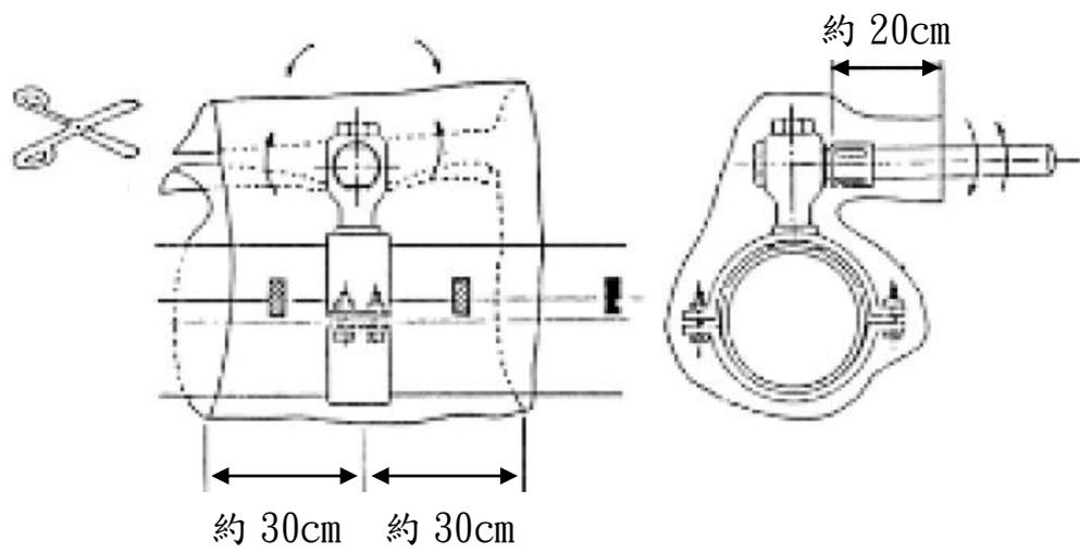
丙、包束剪開的 PE 套膜，使分水鞍完全被包覆，以束線帶分別固定於分水鞍二側、頸部及給水管。
