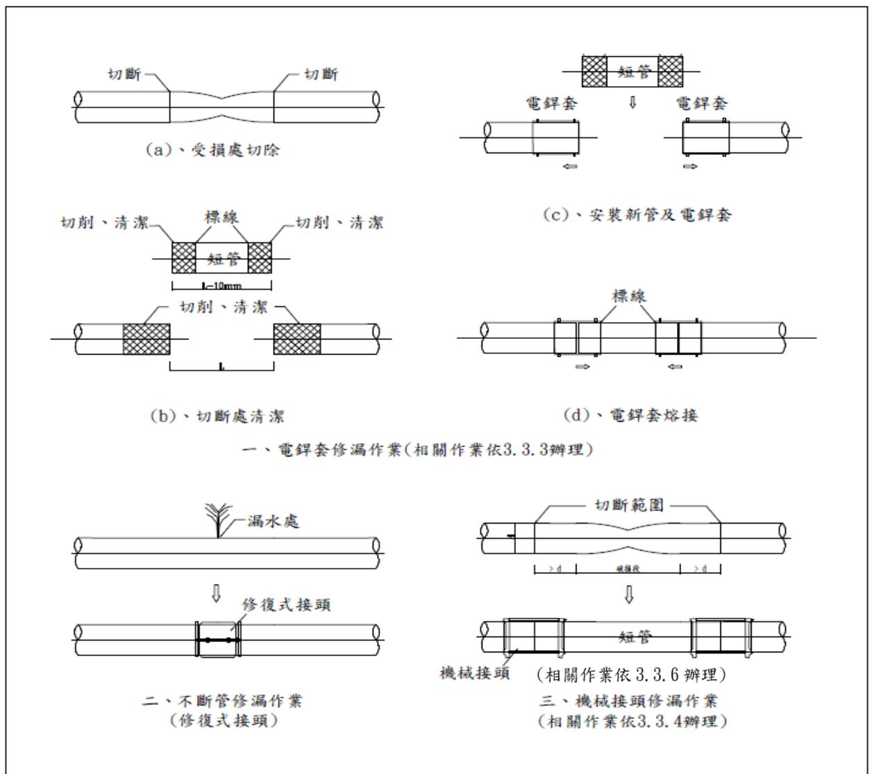
圖 4、HDPE 管線修漏作業示意圖
