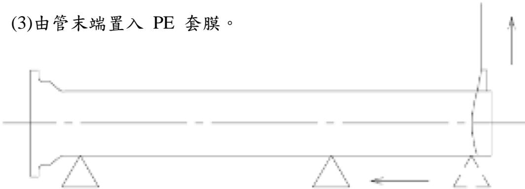
(4)用帆布吊繩將管末端向上抬起、管中支撐枕木向管末端移動、PE 套膜向管中央移動，並整理平順。
