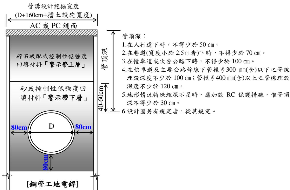
[圖 7、鋼管工地電鍍斷面示意圖]
