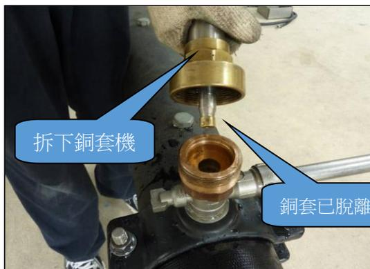
(鬆開轉接頭拆下銅套機)
