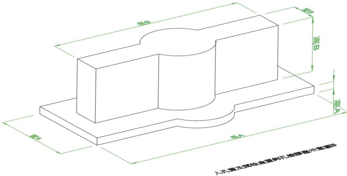
圖二：人孔蓋及閥栓盒蓋鉤孔橡膠塞示意圖 B
