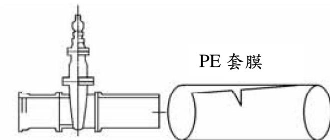
丁、PE 套膜穿入主管後整理平順，以膠帶接合開口部分。
