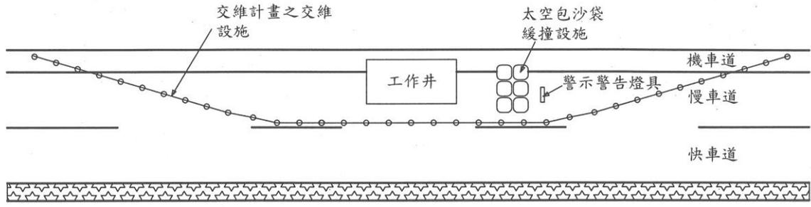
管線推進工程緩撞設施示意圖
