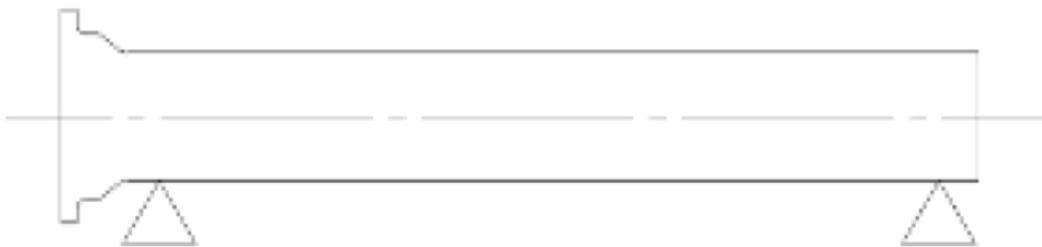
(2)用帆布吊繩將管末端向上抬起，管末端支撐枕木向前移動。
