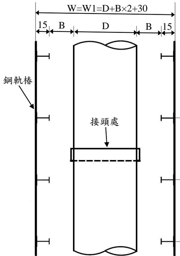
圖 4 鋼軌樁及埋管斷面示意圖
