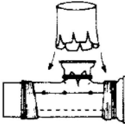
庚、PE 套膜穿入分歧管後整理平順，多餘部分以前述摺疊佈置，再以束線帶固定分歧管末端，另以膠帶密封固定 6 片分隔 PE 膜黏貼主管管身。
