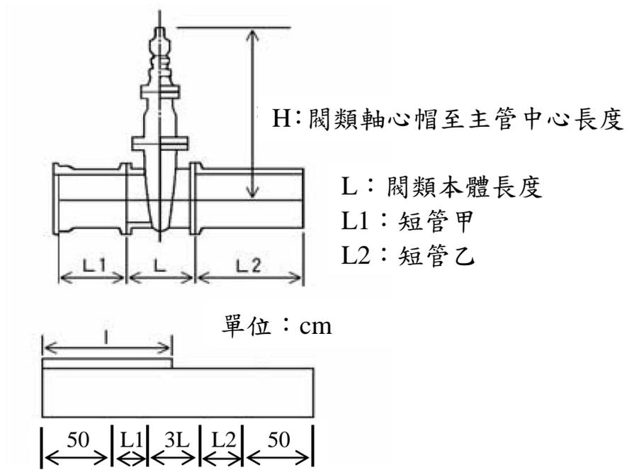
乙、依閥體尺寸剪裁 PE 套膜。
