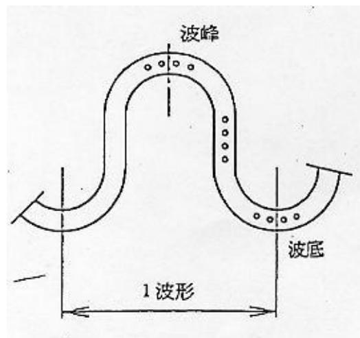
圖 6 硬度試驗測定處
