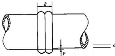
圖 2、HDPE 管熔珠及厚度示意圖
