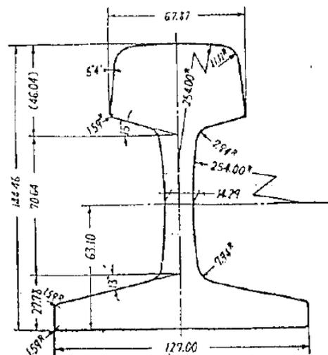
圖 6 50kg 鋼軌示意圖
