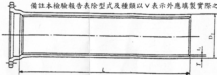
附圖 K 型延性鑄鐵直管接合部示意圖
