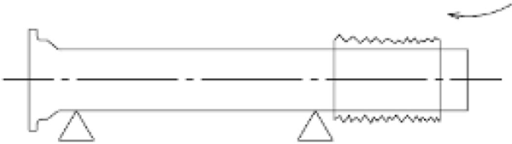
(3)由管末端置入 PE 套膜。
