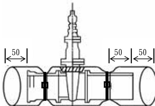
庚、閥體 PE 套膜自上而下套入閥體，並分別於閥頂部以膠帶及閥體頸部以束線帶固定閥體 PE 套膜。
