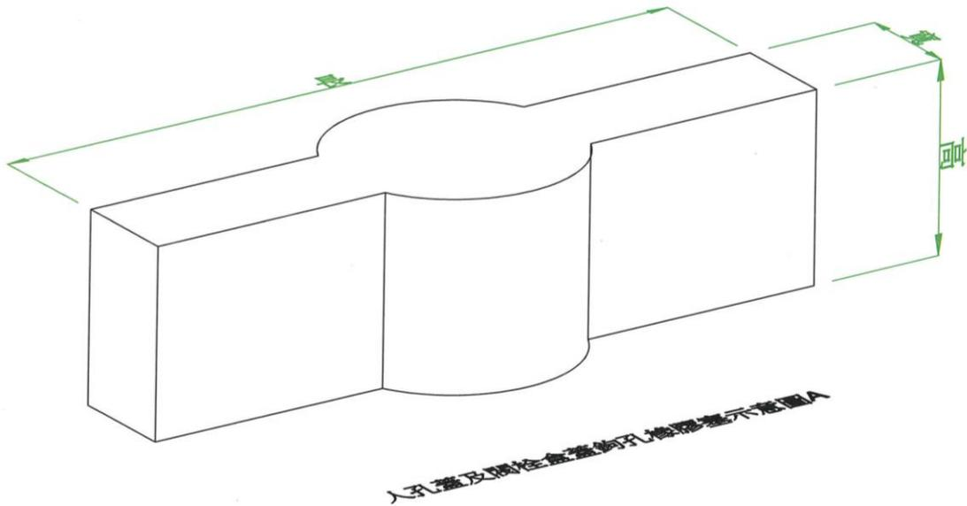
圖一：人孔蓋及閘栓盒蓋鉤孔橡膠塞示意圖 A
