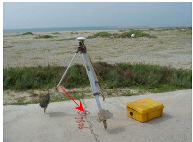
◎作業計畫：九十年度澎湖地區三等控制點補建新建已知點連測 TWD97成果
