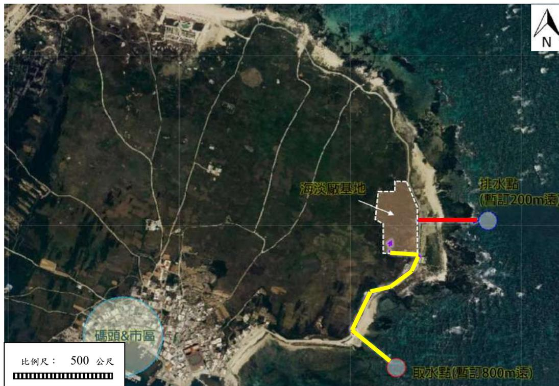
圖 1 吉貝嶼 600 噸海水淡化廠工程預定位置圖(取水口集水管採用沿既有道路與沙灘明挖方式施工 — 黃 — ，鹵水排放管沿既有道路與沙灘明挖方式施工 — 紅 — 。
