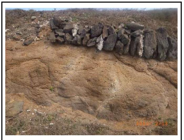
圖示 16：送水管線段，環島道路西側土質，堆積表層為風化沙岩及零星玄武岩碎石，調查圖示位址未發現文化遺物。
