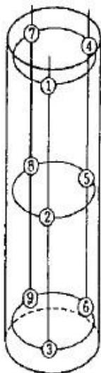
基礎坑、推進井，原則上是在三個不同的深度各選三個測定點分三層實施測定。
