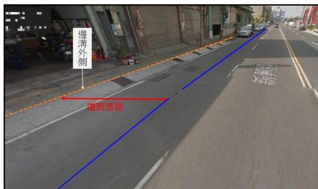
圖二、單側有邊溝，但埋管於另一側，仍以該「邊溝外側線」為量測基準。
