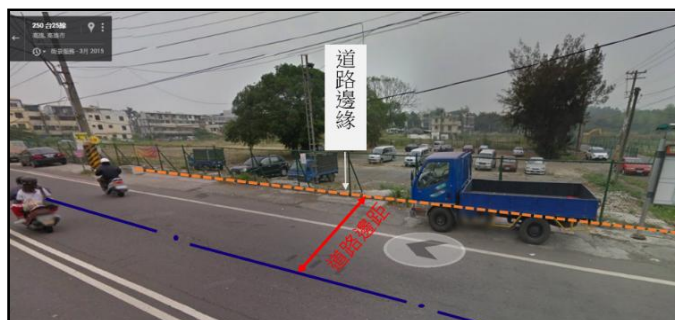
圖九、無邊溝，道路邊緣不易確定，以「鋪面邊緣線」為基準。
