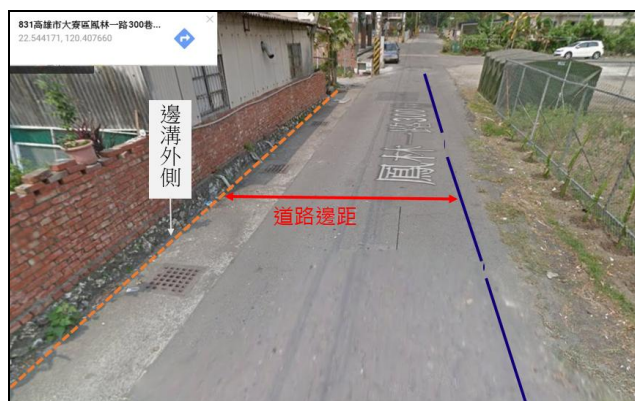
圖三、邊溝埋設在人行道下，以「人行道外側線」為基準。
