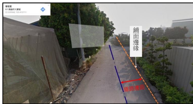
圖十二、無邊溝，道路邊緣不明顯，仍應確認鋪面邊緣，並以「鋪面邊緣線」作為量測基準。
