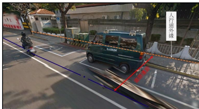
圖五、邊溝在人行道上，以「人行道外側線」為基準。
