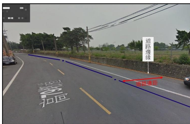
圖八、無邊溝，無人行道，道路邊緣明顯，以「路邊緣線」為量測基準。
