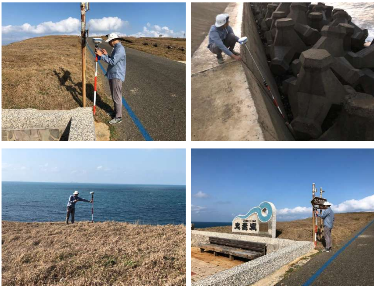
圖 3-2 即時衛星動態定位測量作業照
