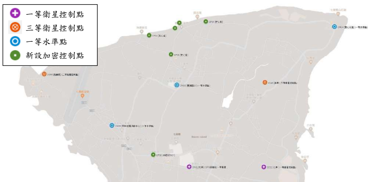
圖 2-1 七美測量規劃控制點分佈圖
