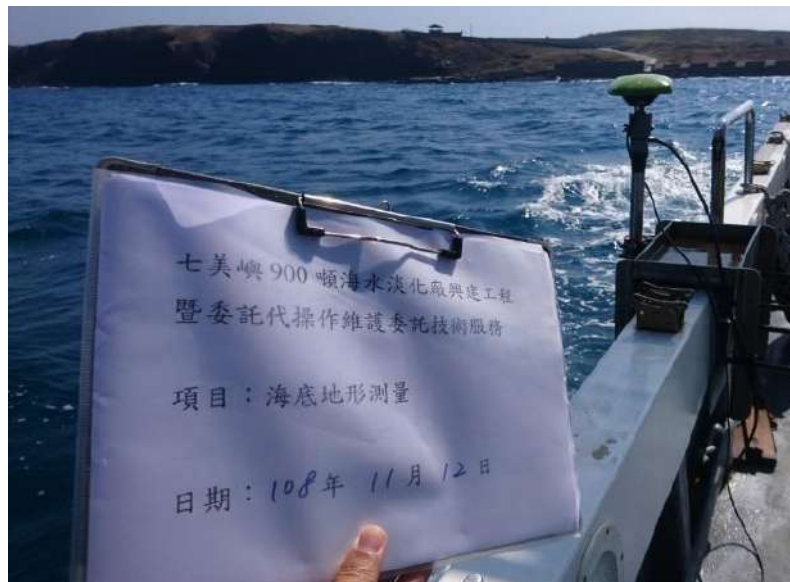
圖 4-3 衛星接收儀架於測深船
