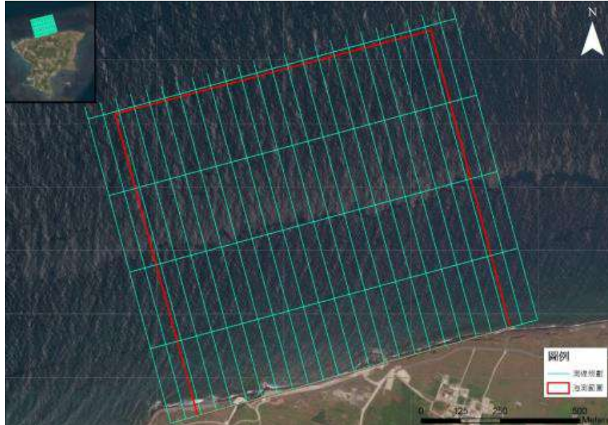
圖 3.2-3 海底地形測量範圍與測線規劃圖
