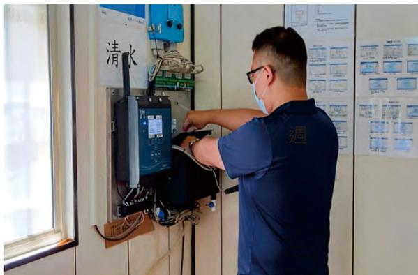
▲圖 3-5 建築工地線上水質監測儀器
