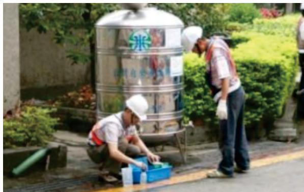
▲ 圖 4-54 臨時供水站儲水桶水質檢測
