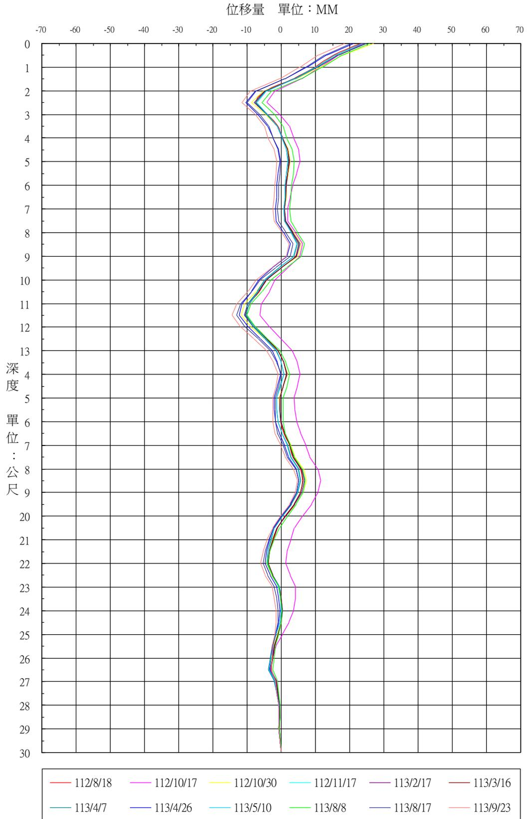
圖2.8-1 傾斜管測量位移量曲線圖(SI1-A)
