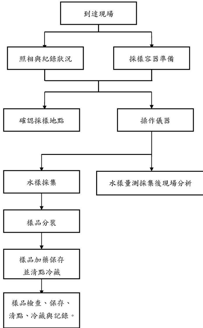
圖1.5-1 水質採樣測定作業流程圖
