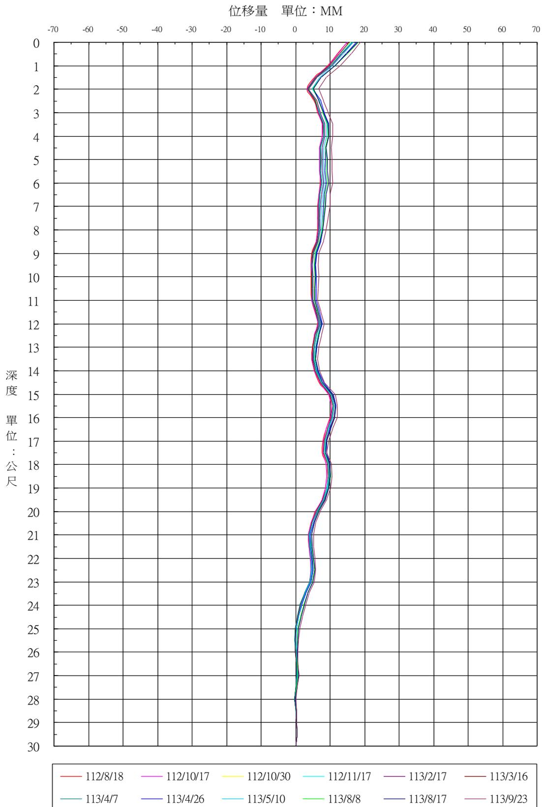
圖2.8-2 傾斜管測量位移量曲線圖(SI1-B)
