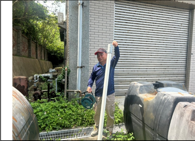
傾斜管觀測-水位量測(115.03.31地震後)
