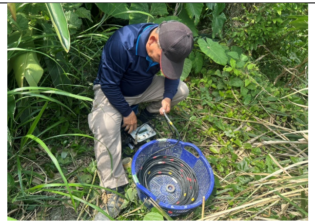
傾斜管觀測-量測(115.03.31 地震後)
