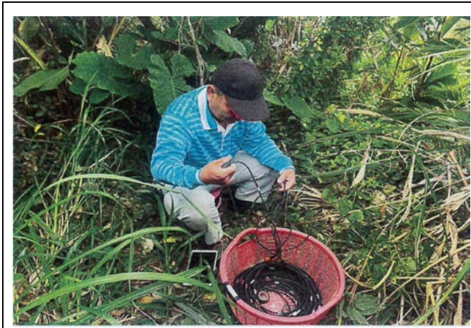
傾斜管觀測-量測(115.02.25)
