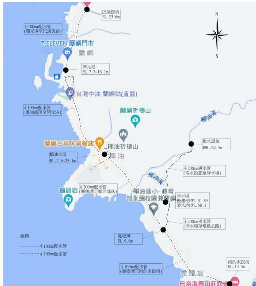
圖 4.2-1 椰油供水系統平面配置圖
