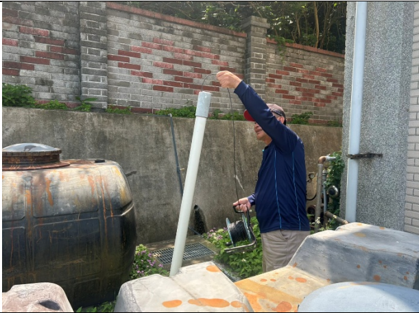
傾斜管觀測-水位量測(115.05.26 地震後)
