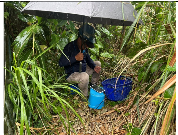
傾斜管觀測-量測(115.05.15地震後)
