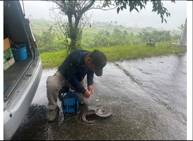
傾斜管觀測-水位量測(115.05.15 地震後)
