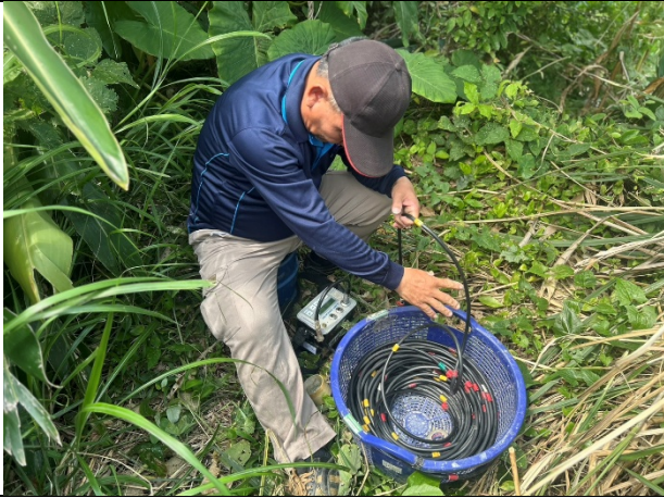
傾斜管觀測-量測(115.05.26 地震後)
