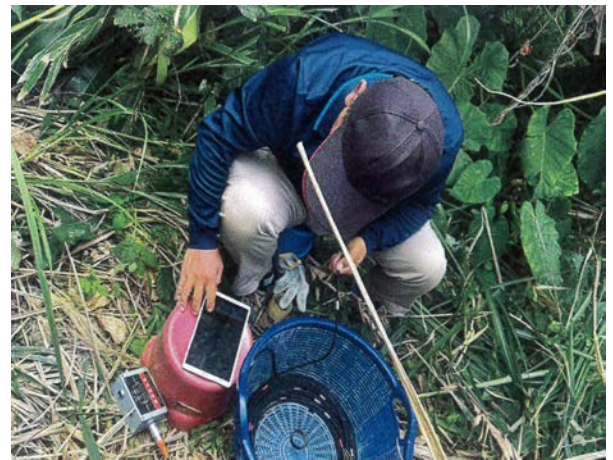
傾斜管觀測-量測(115.05.05)
