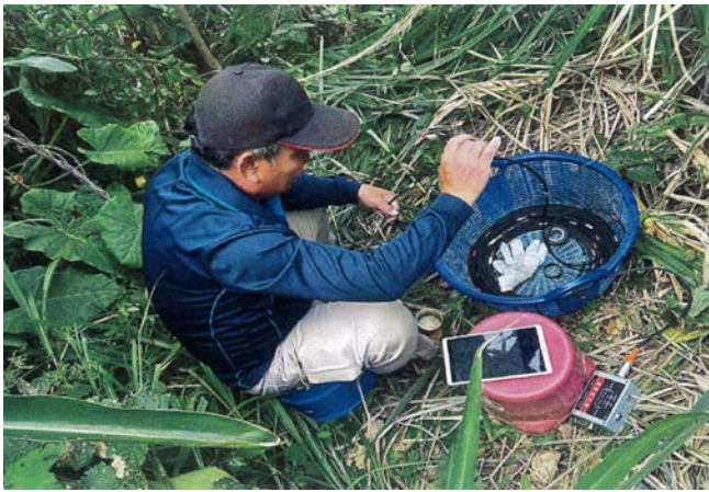
傾斜管觀測-量測(115.05.05)
