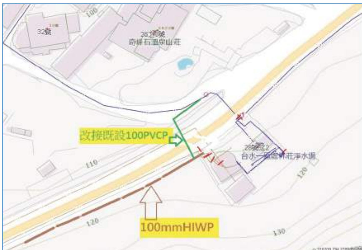
圖2-2-45 管線改接示意圖
