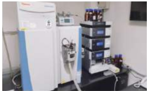
圖2-3-5 液相層析質譜儀檢驗塑化劑
