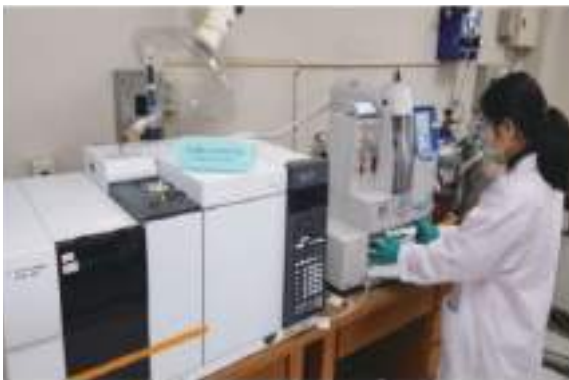
圖2-3-4 氣相層析質譜儀檢驗揮發性有機物
