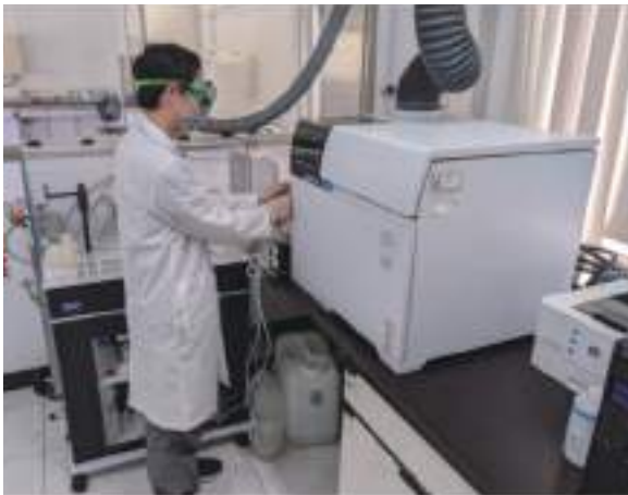
圖2-3-2 感應耦合電漿質譜儀檢驗重金屬
