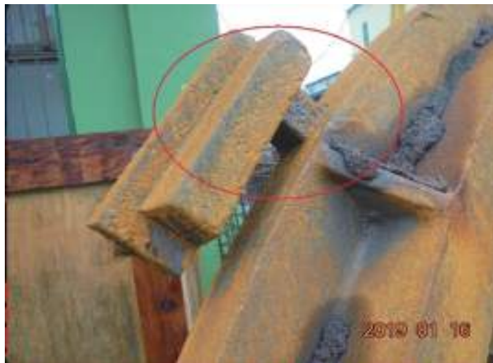
圖2-7-2 特殊閥類鑄件試棒須連結在原鑄件上
