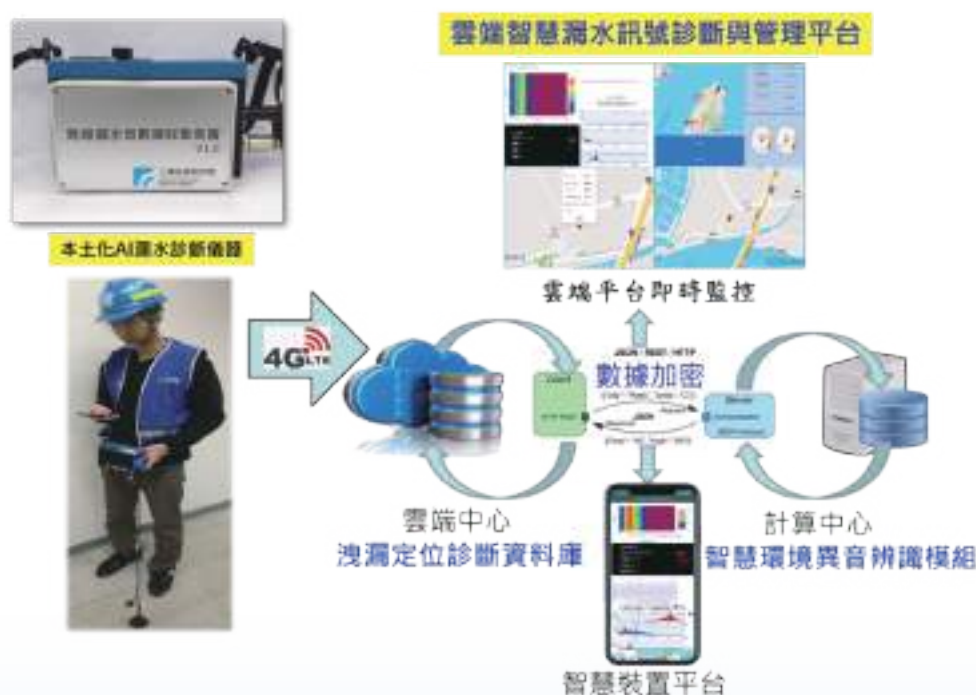
圖2-2-56 AI輔助漏水辨識系統
