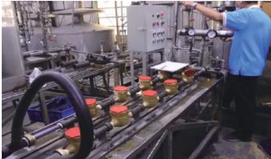
圖2-7-3 水量計器差檢驗時蓋上頂蓋
