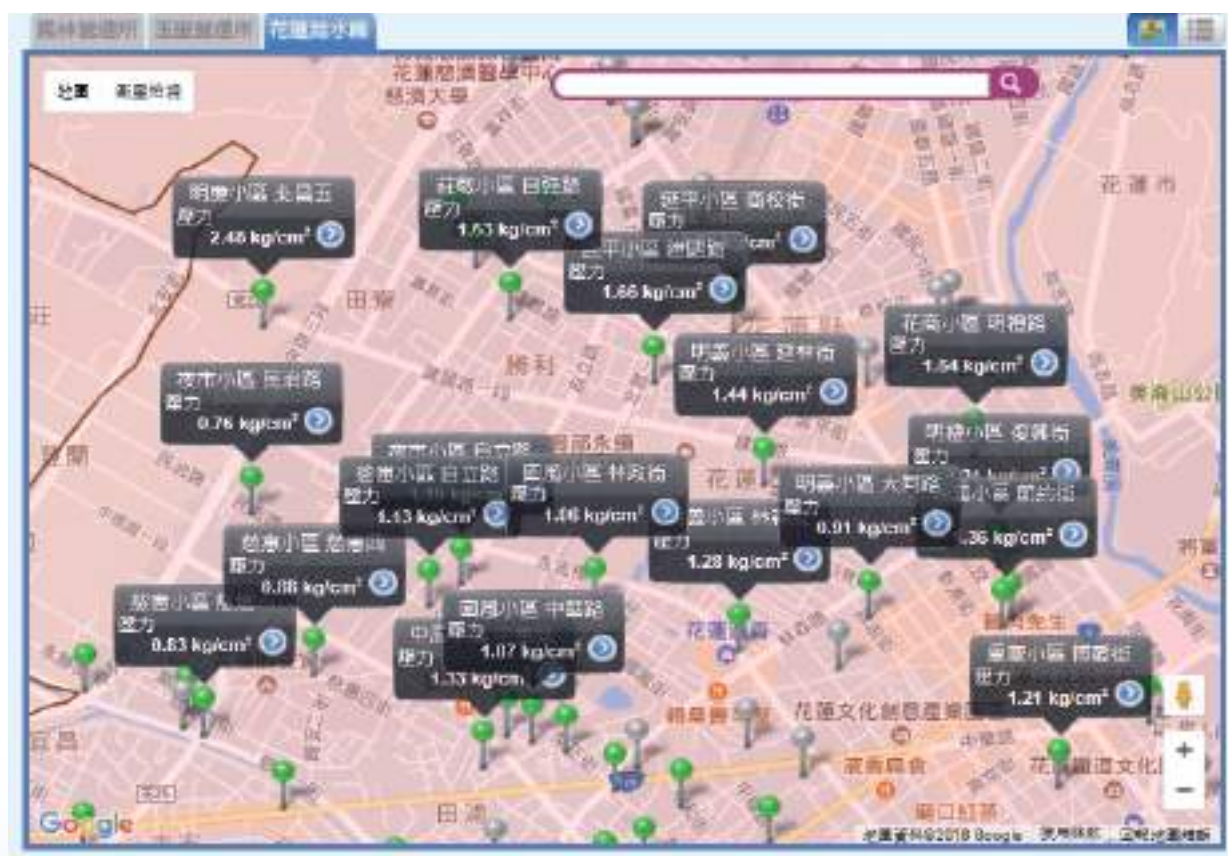
圖2-2-20 供水監測平台上各水壓監測站之復原時期水壓即時監測
