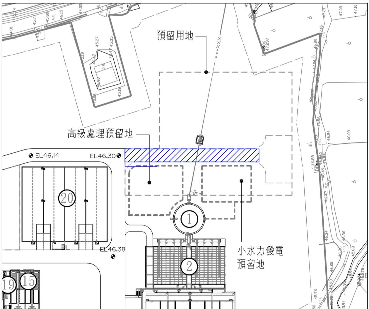
\*須設置小水力發電設備通行道路(含排水側溝)
