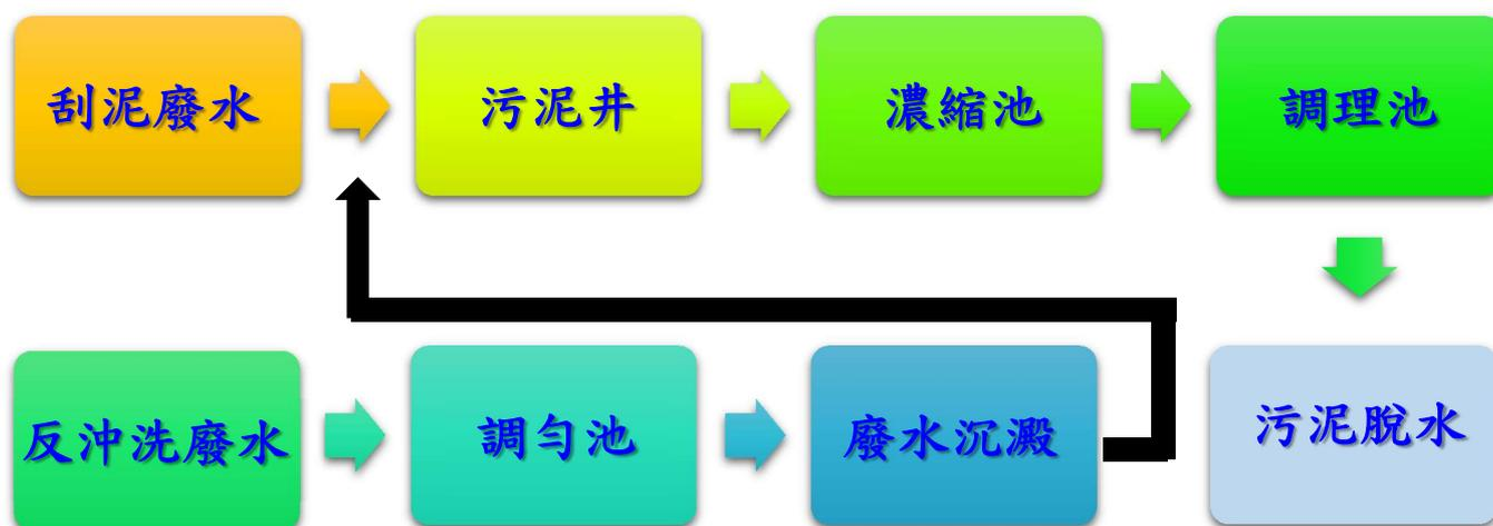
自來水在淨水處理過程中，污泥產生的主要來源是快濾池的反沖洗廢水及沉澱池底層的沉澱排放。而反沖洗的廢水經過調勻、沉澱後與刮泥的廢水一起進入到污泥井，再經由濃縮、調理及脫水處理，最後變成污泥餅。
