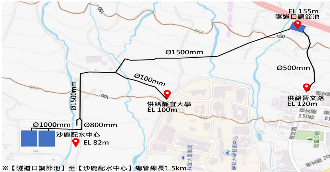
圖一、隧道口調節池至沙鹿配水中心導水管線配置平面圖
