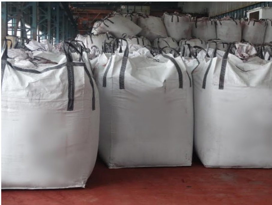
「太空包沙袋」示意圖 規格：長 100cm(±10cm)*寬 100cm(±10cm)*高 110cm(±10cm)
