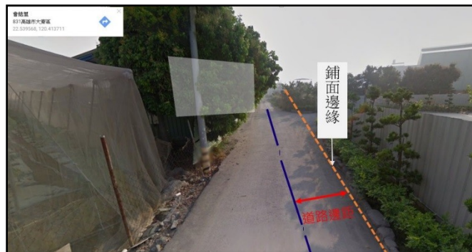
圖十二、無邊溝，道路邊緣不明顯，仍應確認鋪面邊緣，並以「鋪面邊緣線」作為量測基準。
