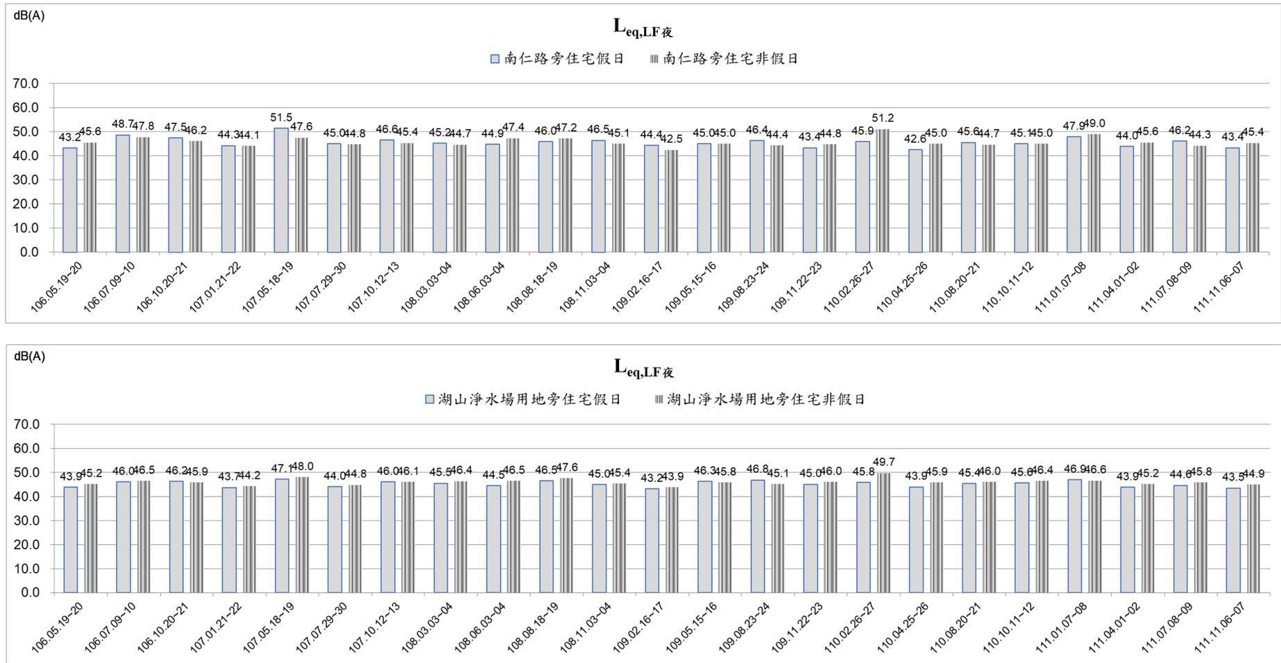
圖 2.2- 3、低頻噪音監測結果彙整圖( $L_{eq,LF}$  夜)
