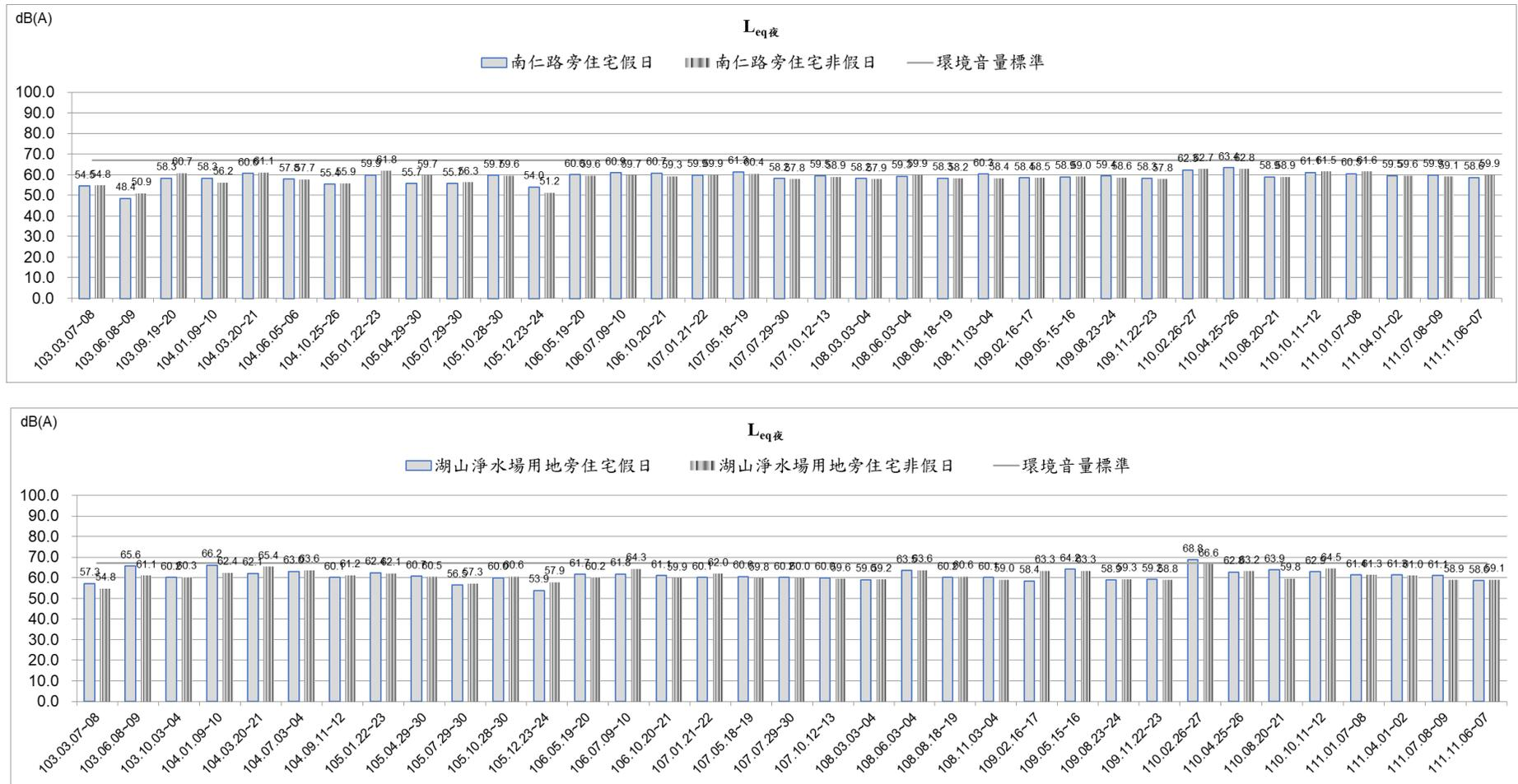
圖 2.1- 3、噪音監測結果彙整圖( $L_{eq夜}$ )
