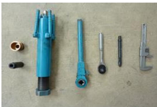
(十字鑽孔機及施工工具)
