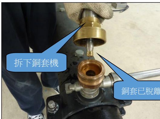
(鬆開轉接頭拆下銅套機)
