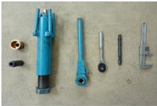
(十字鑽孔機及施工工具)
