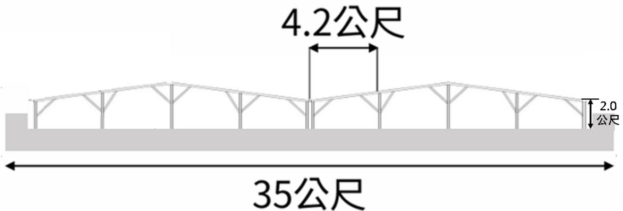
採落柱方式施作，支架須使用鋼構或強度以上之材料(且須符合租賃契約第三條規
