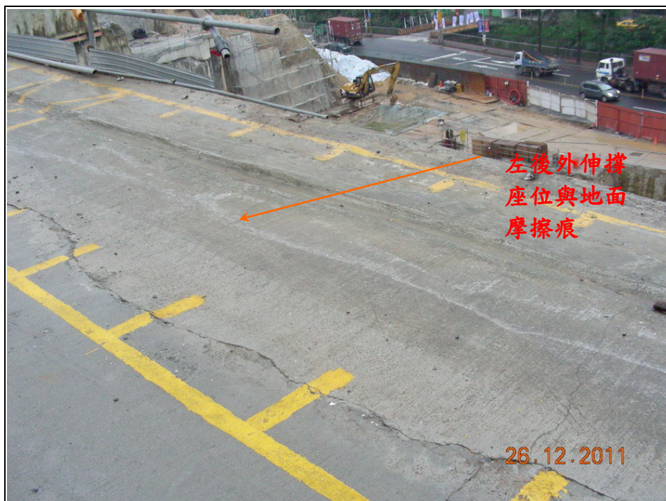
照片 7 操作手壓下左後操作桿，想用左後撐座定住車身，撐座與地面產生摩擦痕。
