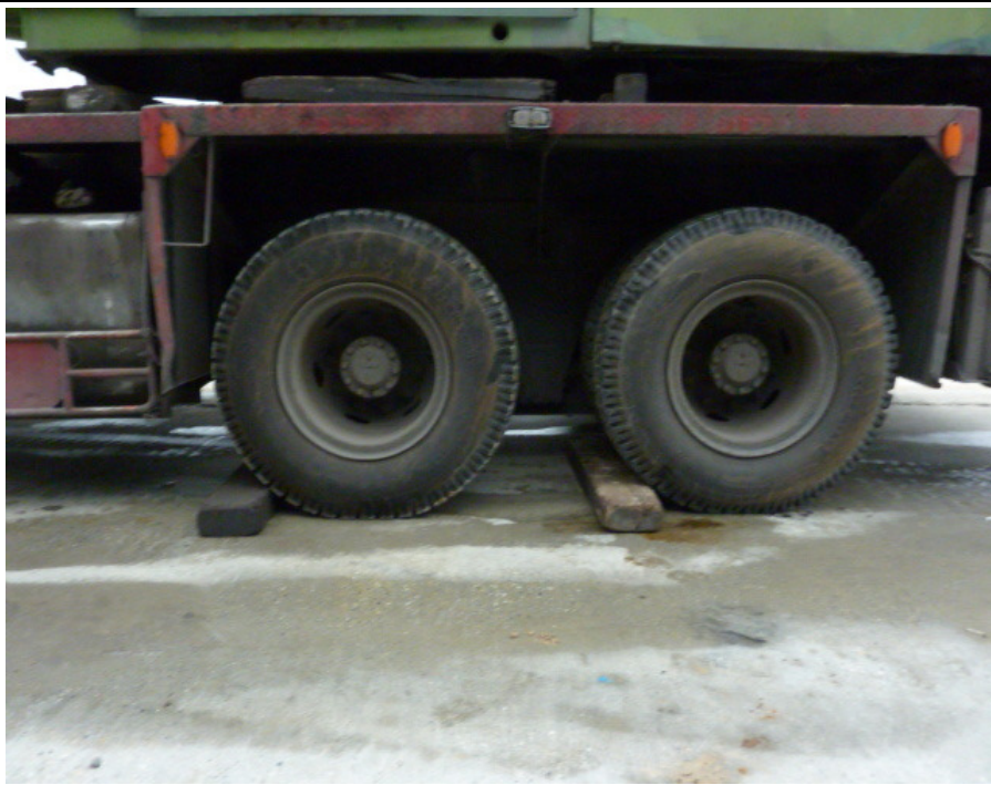
照片 3 工區現場以同類型之起重機，肇災前之枕木放置情形。
